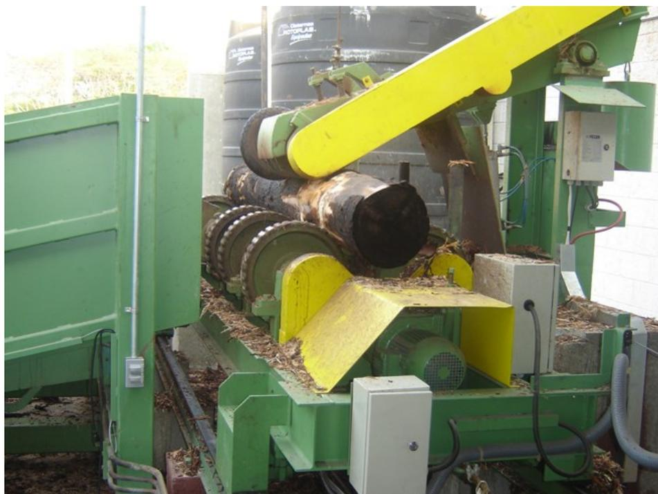
Figura 2.7 - Descascador de madeira. Fonte: (FEZER, 2021)
