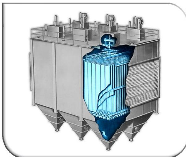
Figura 2.11 - Precipitador Eletrostático. Fonte: MACDARMA (2021)
