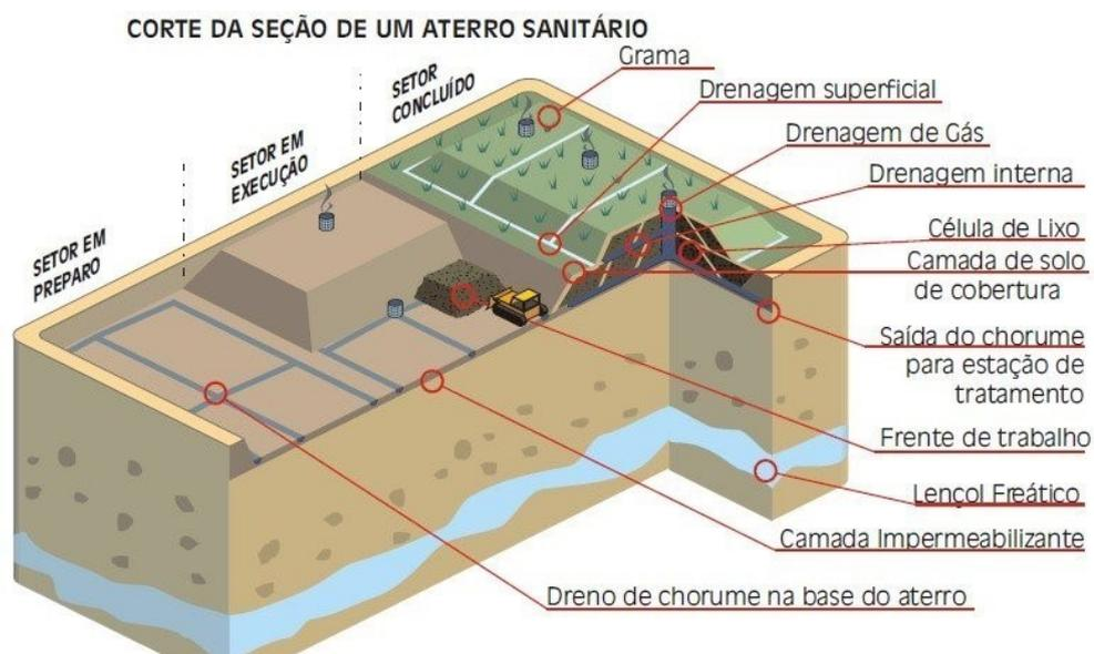
Figura 2.15 - Esquema de um aterro sanitário. Fonte: PRS (2021)
