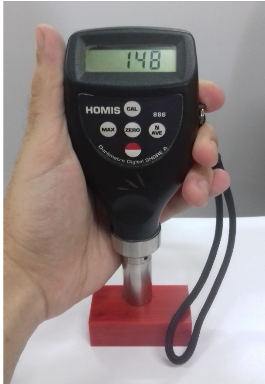
Figura 18 - Medição de Dureza Shore A em superfície da amostra.
