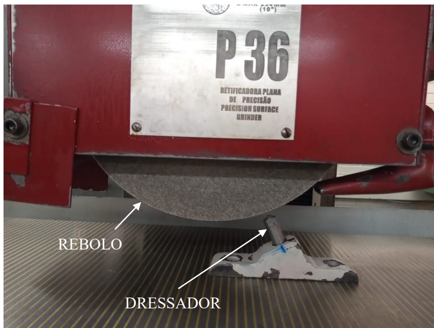
Figura 15 – Montagem do dressador de ponta única para a dressagem do rebolo.
