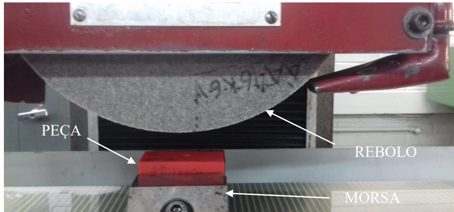
Figura 14 – Montagem da peça para execução do ensaio de retificação.
