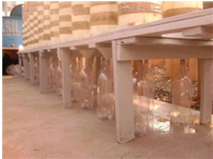
**Figura 2.** Garrafas "PET" para a coleta da solução do solo (lixiviado).
