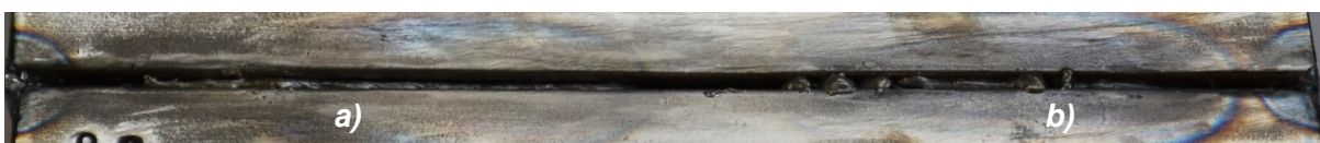
Figura 31 - Penetração da solda corpo de prova 1. a) “puxando”; b) “empurrando”. (Autor).
