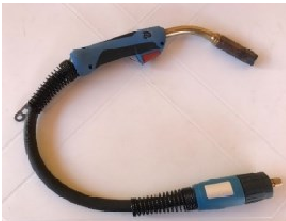
Figura 20 - Tocha utilizada para os testes. (MARTINS, 2018).
