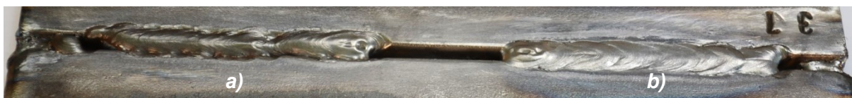
Figura 32 - Cordões de solda do corpo de prova 2. a) "puxando"; b) "empurrando". (Autor).
