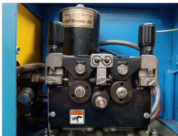
Figura 5 - Sistema alimentador de arame. (Autor).
