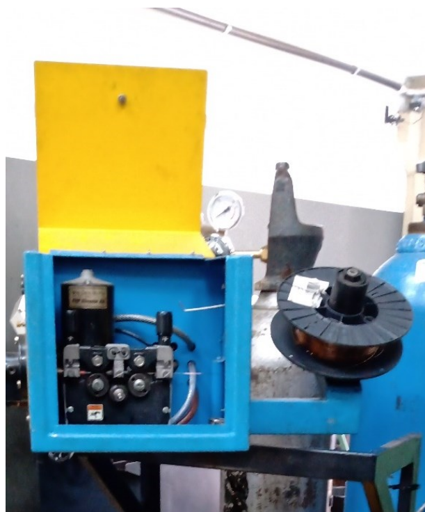
Figura 17 - Cabeçote alimentador de arame. (Autor).
