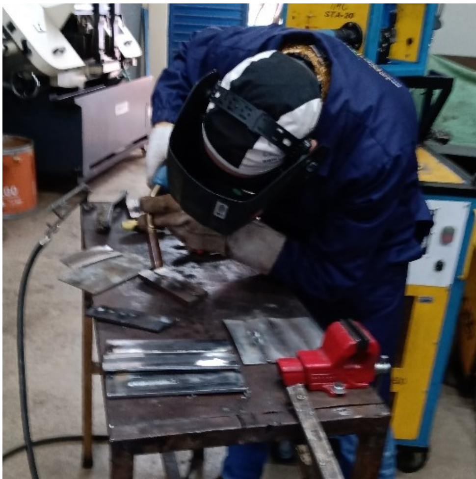
Figura 22 - Soldador utilizando os equipamentos de proteção. (Autor).
