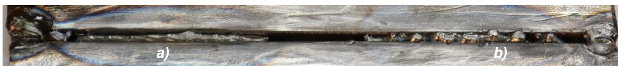
Figura 33 - Penetração da solda corpo de prova 2. a) "puxando"; b) "empurrando". (Autor).
