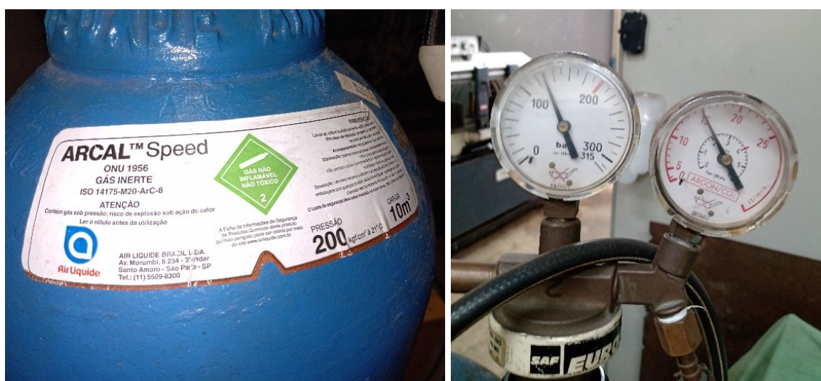
Figura 21 - Gás de proteção e instrumentos de medição de pressão e vazão. (Autor).
