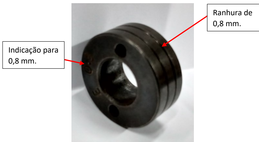
Figura 18 - Rolete de tração de 0,8 e 1,0 mm. (Autor).
