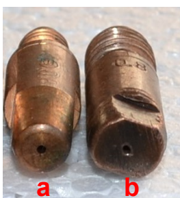
Figura 27 - Bico de contato \varnothing 0,8 mm. a) Bico original e b) Bico adaptado. (Autor).
