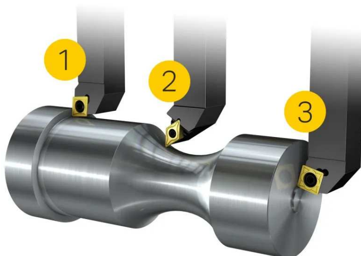
Figura 2.7 - Torneamento longitudinal (1), torneamento de perfil (2) e faceamento (3). (Sandvik Coromant)
