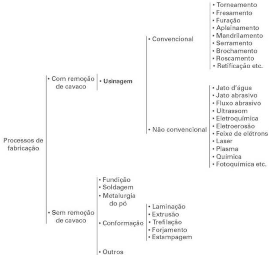
Figura 2.1 - Classificação dos processo de fabricação (MACHADO et al., 2009)
