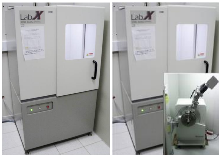
Figura 23. Difratorômetro utilizado para medidas de difração de raios-X (Shimadzu XRD-6000), disponível no Laboratório Multiusuários do Instituto de Química, da Universidade de Uberlândia.
