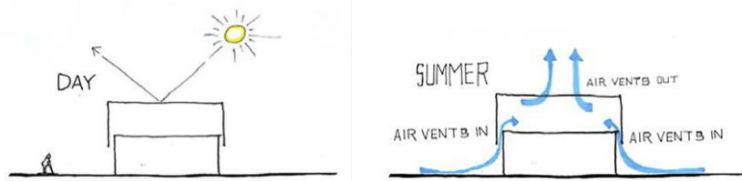
Figura 45: Reflexão e sistema de ventilação da coberturas das residências. 2014. Fonte: ArchDaily.
