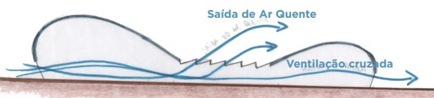
(137) Croqui esquemático do sistema de ventilação natural no ginásio
