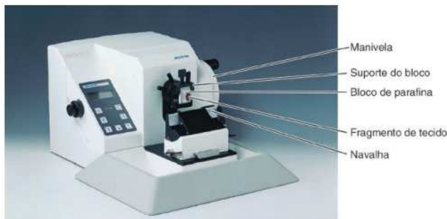
Figura 2 – Micrótomo para cortar tecidos incluídos em parafina. Acionando-se a manivela (à direita da figura), o bloco contendo o fragmento de tecido sobe e desce. Após cada volta da manivela, o bloco avança uma distância definida (geralmente de um a dez \mu\text{m} ) e, ao passar pela navalha, deixa uma fatia do tecido (JUNQUEIRA; CARNEIRO, 2018).
