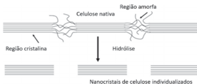
Figura 8: Esquemática da produção de nanocristais de celulose.
