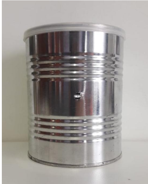
Figura 8 – Pinhole feita com lata de leite em pó
