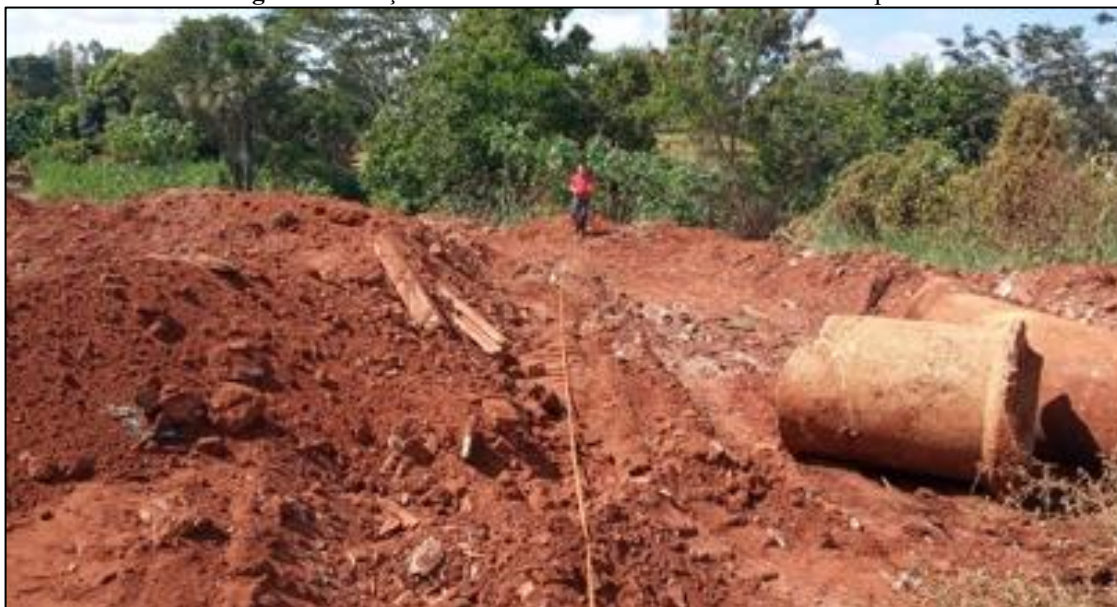
Figura 12: Voçoroca sendo medida durante trabalho de campo
