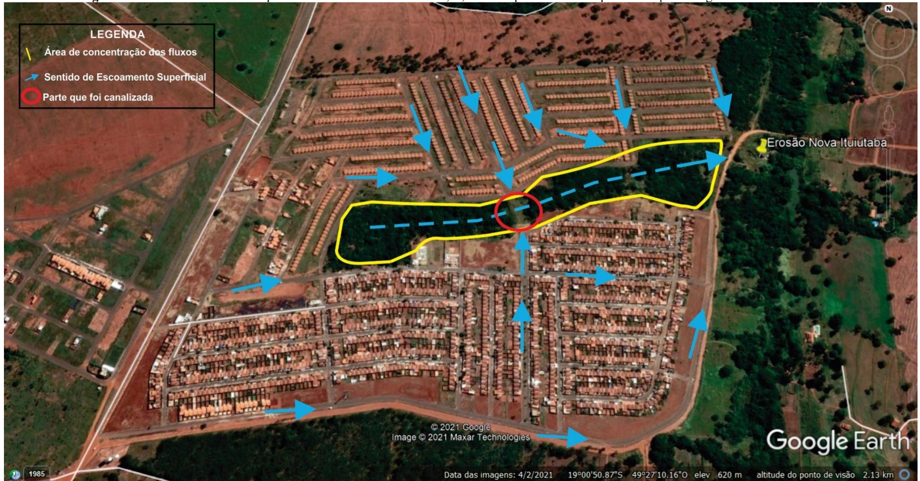
Figura 21: Sentido de escoamento pluvial do Bairro Nova Ituiutaba I, II, III e IV que contribuirão para formação da segunda erosão identificada
