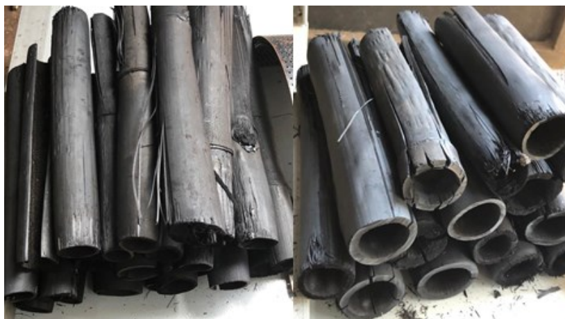
Figura 4. 6 – Carvão de bambu produzido via pirólise lenta.
