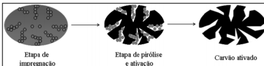
Figura 2. 6 – Esquema representativo da ativação química
