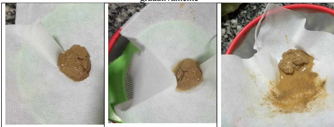
Figura 13: Sequência de alteração QUÍMICA na argila após pingar as gotas de vinagre gradativamente
