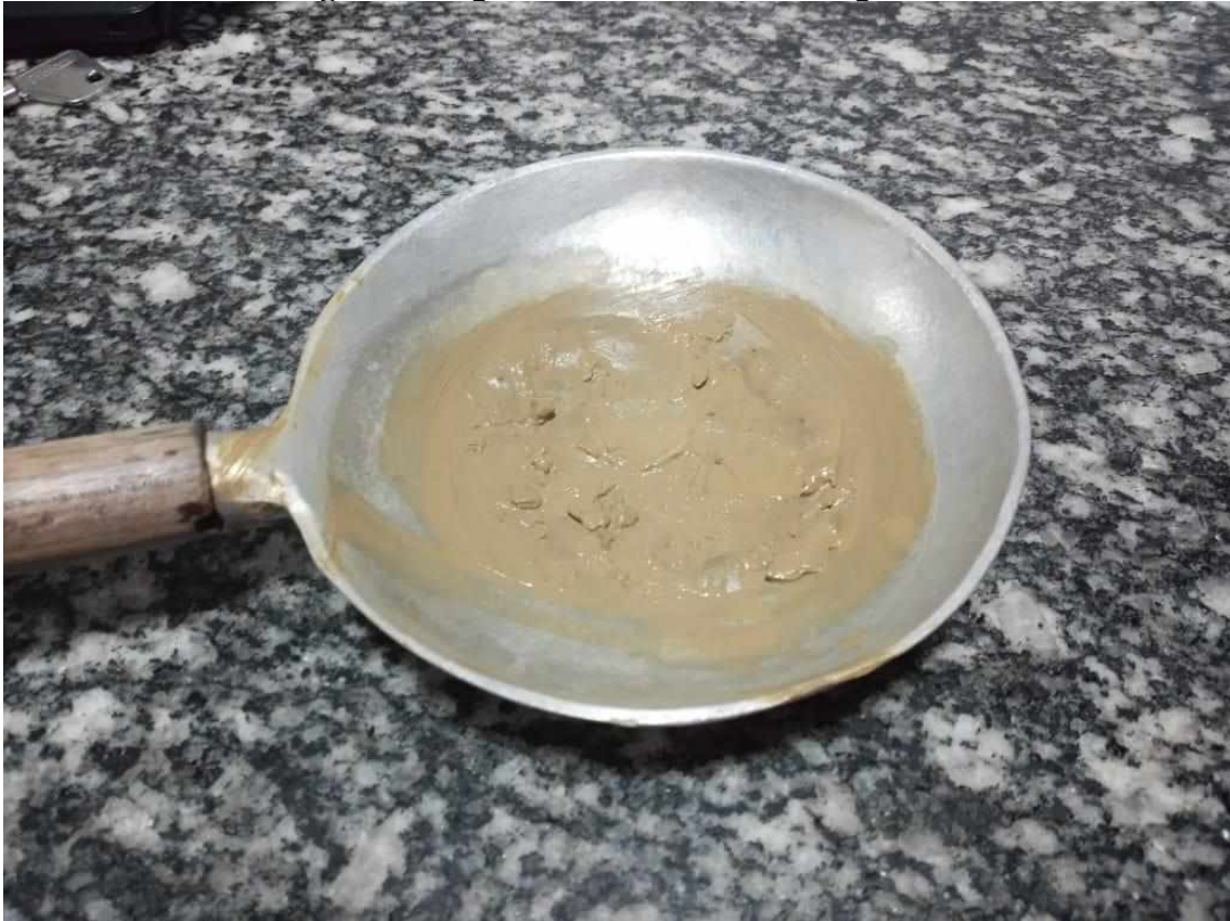
Figura 9: Argila cobrindo o fundo da frigideira
