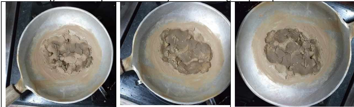
Figura 11: Sequência de alteração física na argila após aquecimento
