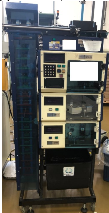
Figura 12. Equipamento de medição de queda de pressão.
