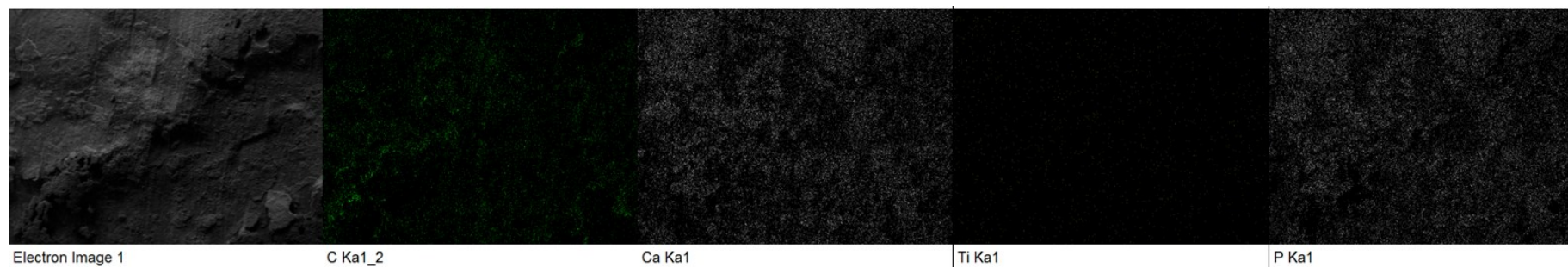
Figura 7.3.5 – Distribuição dos principais elementos químicos em amostra do Ensaio 3 (sem limpeza ultrassom).
