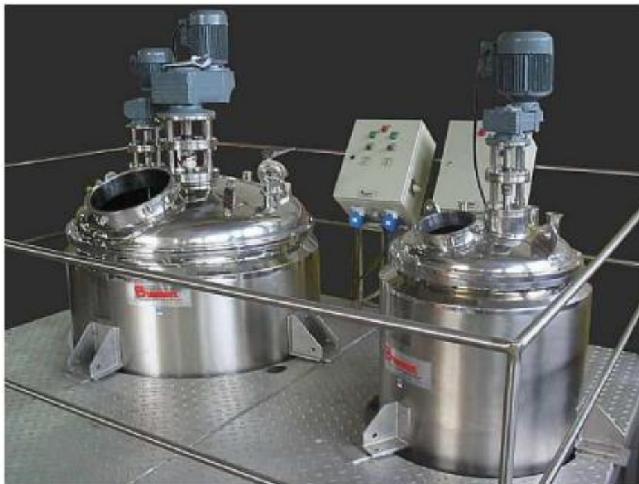
Figura 7 - Vista superior de tanques reatores com controle de temperatura. 15
