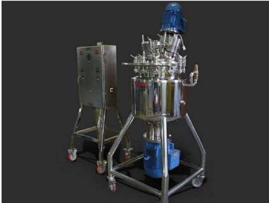
Figura 8 – Tanque de reator utilizado na produção de condicionadores e xampus. 15
