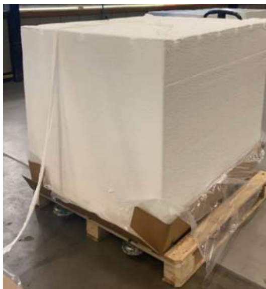
Figura 8 - Fardo de cabo de acetato prensado
