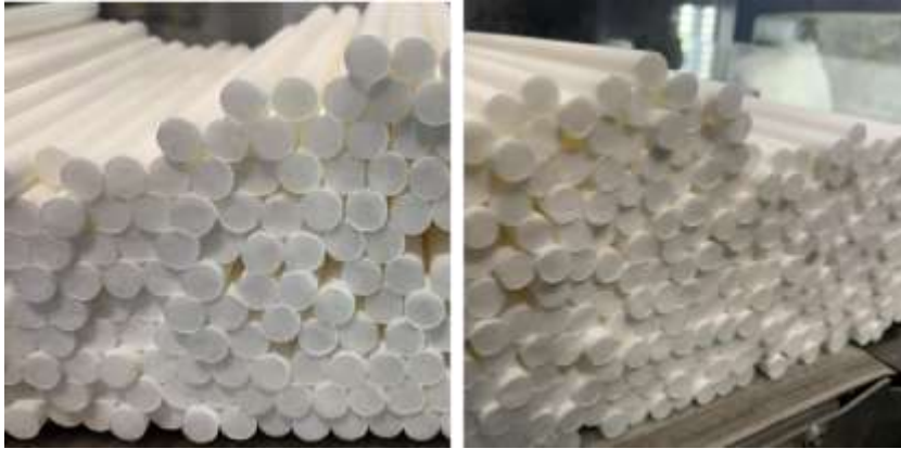
Figura 11 - Barras de filtro
