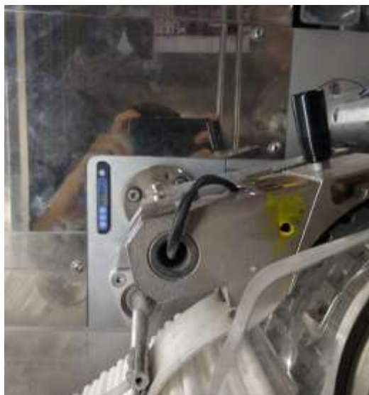
Figura 17 - Contador de barras de filtro do equipamento DF-10
