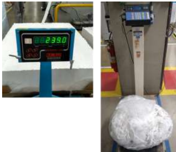
Figura 21 - Pesagem do estrago gerado na fabricação das barras de filtro
