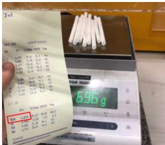
Figura 24 - Comparação entre os valores médios de peso total da barra da balança de precisão e do QTM
