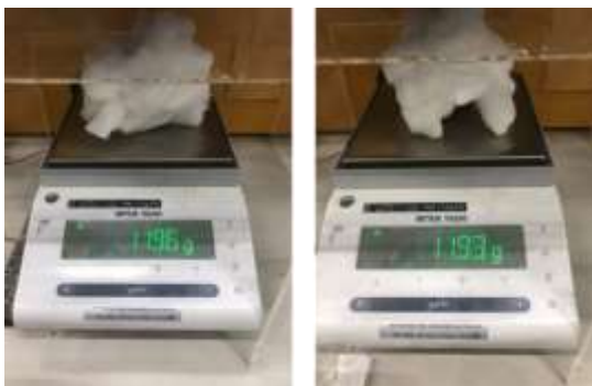
Figura 22 - Pesagem de filtros sem triacetina em balança de precisão
