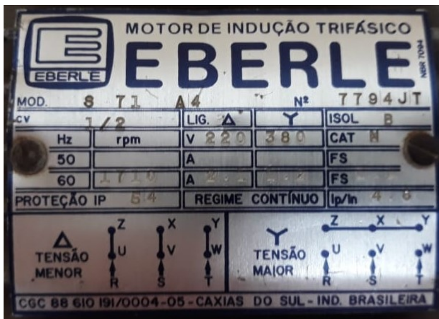
Figura 19 - Dados de placa MIT 1/2 CV (MOTOR 01)
