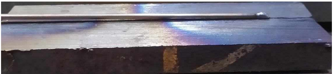
Figura 26: Disposição da vareta de metal de adição na folga das chapas
