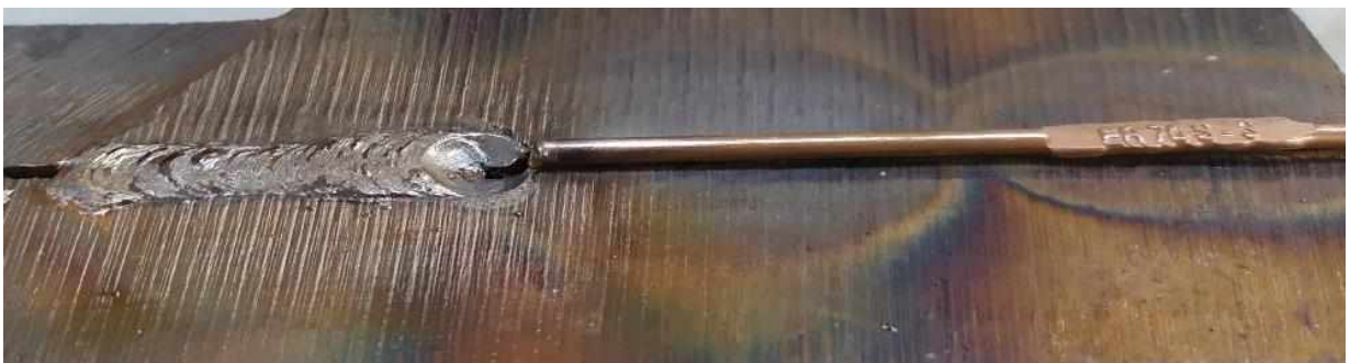
Figura 30: Solda com o processo de Benardos - Com metal de adição – 120 A
