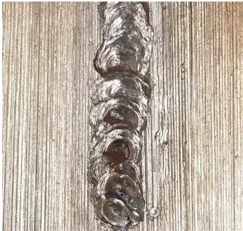
Figura 24: Solda processo de Benardos - Sem metal de adição
