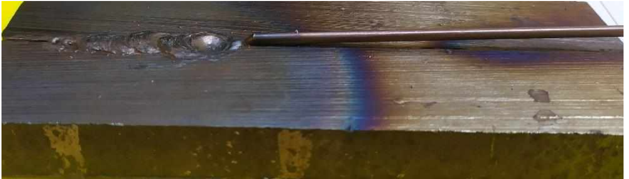
Figura 27: Soldagem processo de Bernardos - Com metal de adição
