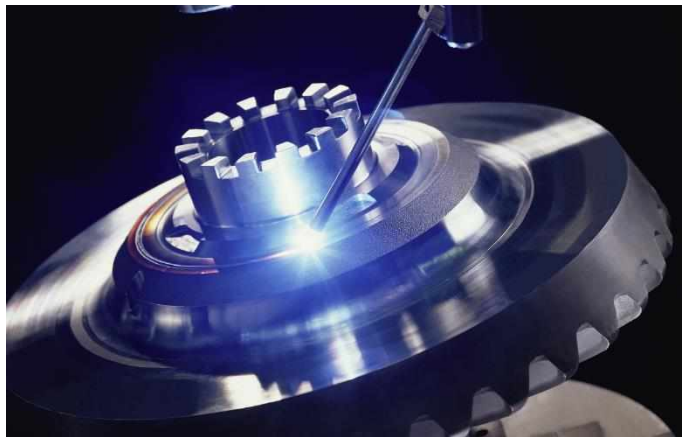
Figura 4: Soldagem laser - Autodata
