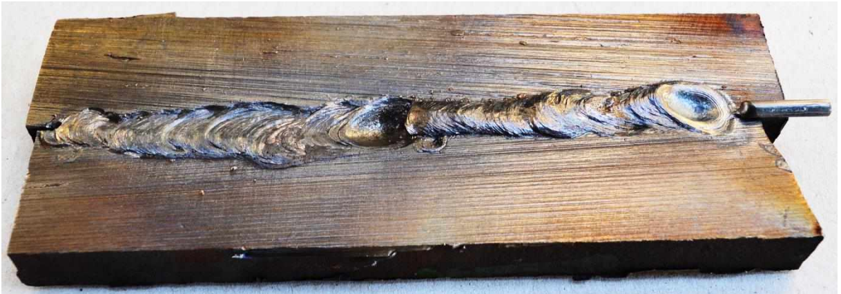
Figura 31: Solda sem metal de adição (esquerda) – Solda com metal de adição (direita)
