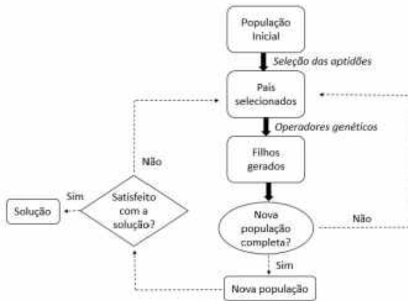
Figura 5 – Fluxograma do funcionamento de um algoritmo genéticos. Disponível em (RODRIGUES et al., 2018).
