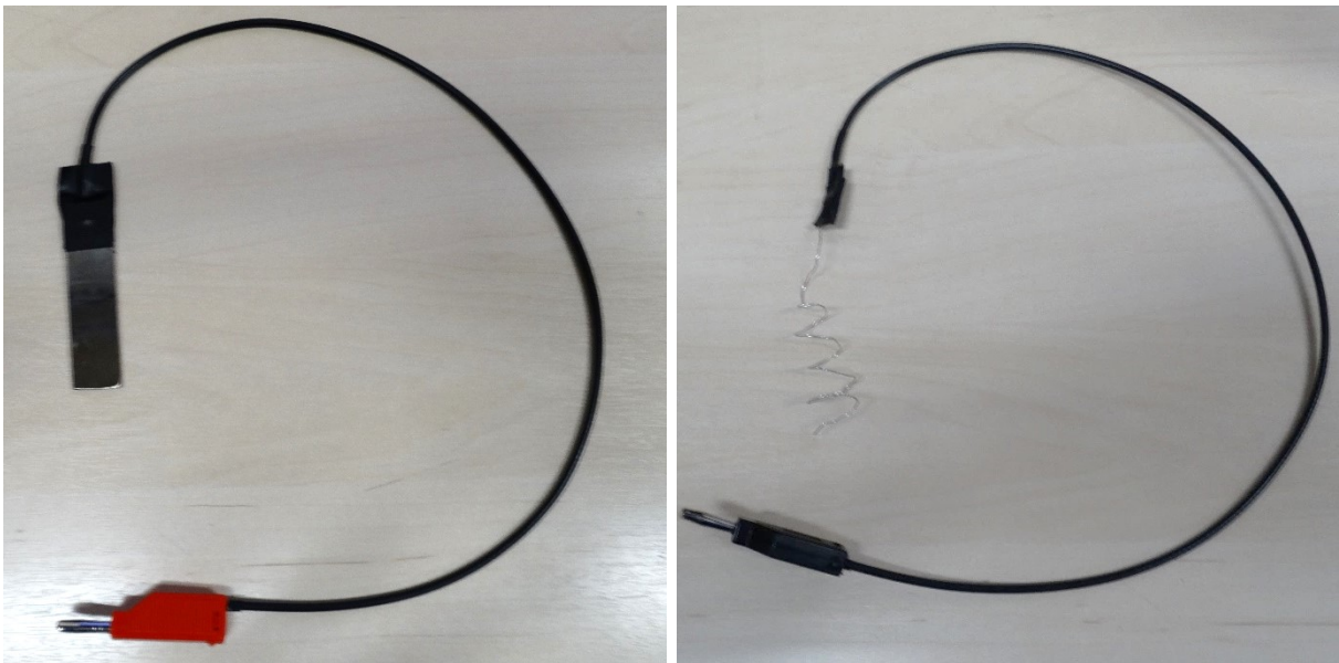
Figura 33 – Eletrodo de trabalho (à esquerda) e contraeletrodo (à direita) utilizados nos ensaios de validação do galvanostato.
