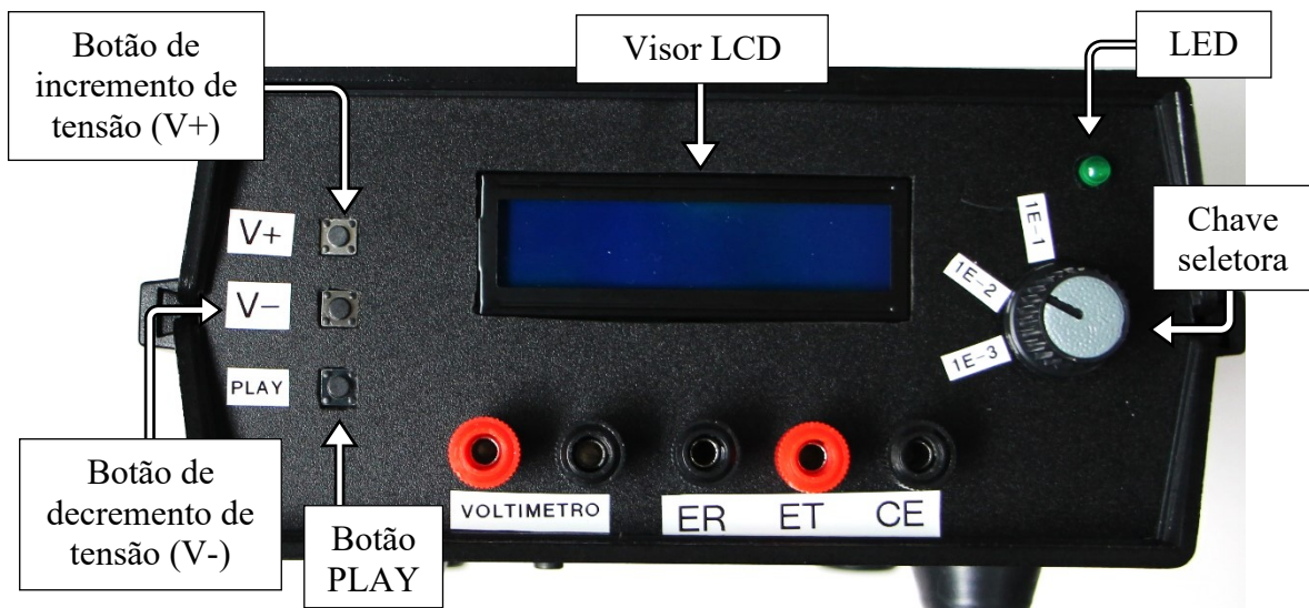
Figura 30 – Painel frontal do galvanostato. ER indica o conector para o eletrodo de referência. ET indica o conector para o eletrodo de trabalho. CE indica o conector para o contraeletrodo.
