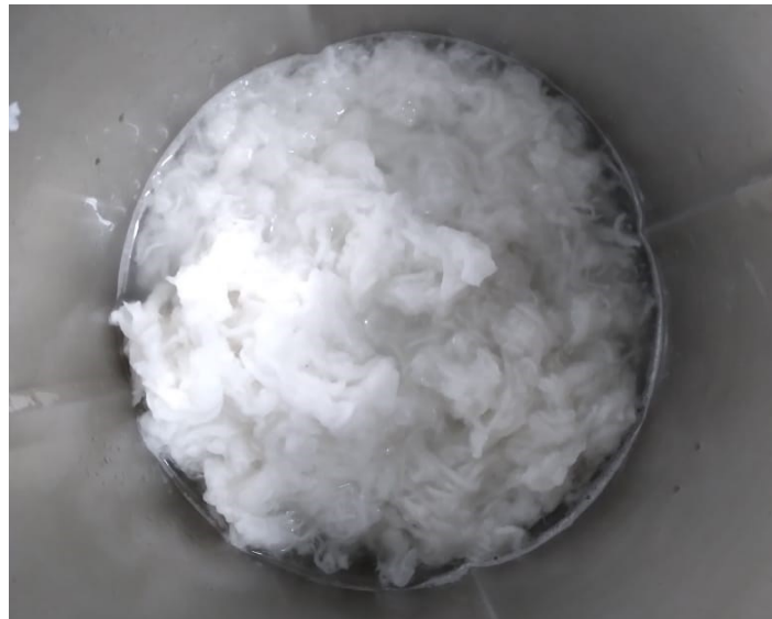
FIGURA 5: Fibra de acetato de celulose dispersa na água da mistura
