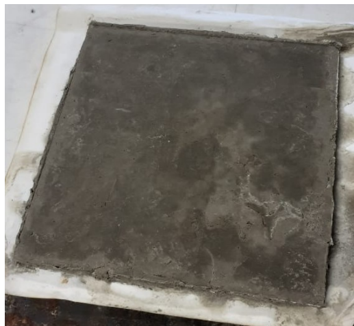
FIGURA 10: Placa moldada após prensagem
