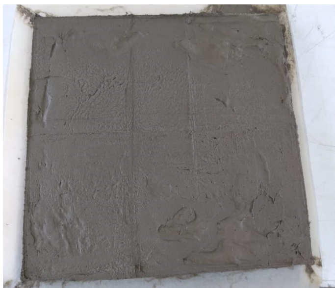
FIGURA 8: Placa moldada pela simulação do processo Hatschek
