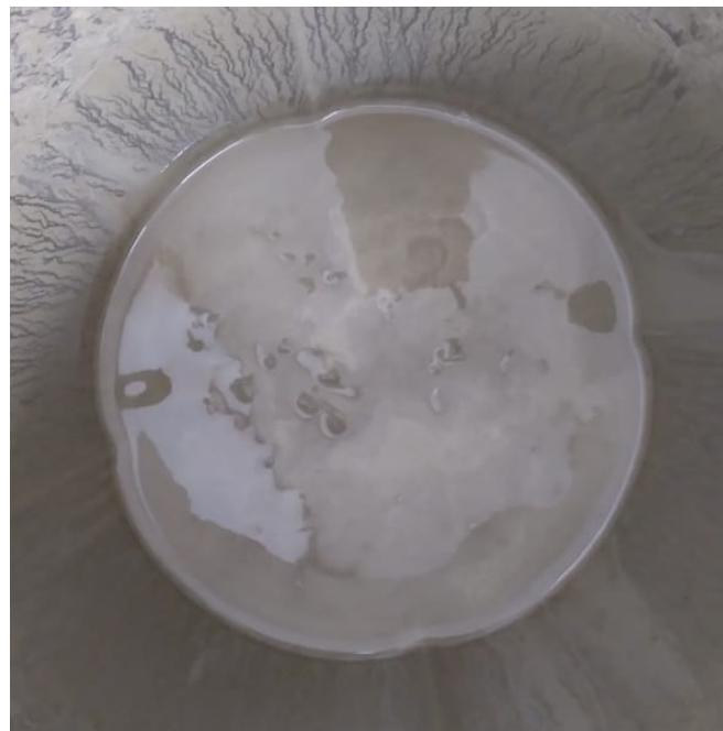
FIGURA 6: Misturada fluida de cimento, água e fibra de acetato de celulose
