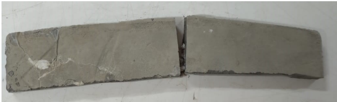
FIGURA 13: Seção longitudinal do corpo de prova após a ruptura
