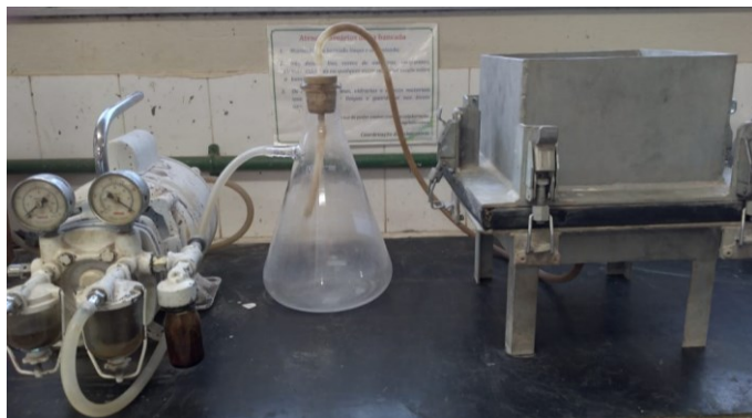
FIGURA 7: Dispositivo utilizado para a moldagem das placas dos compósitos
