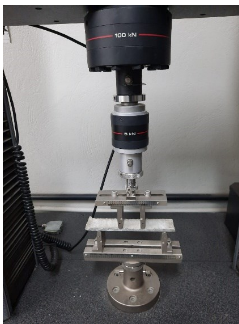
FIGURA 12: Ensaio de flexão
