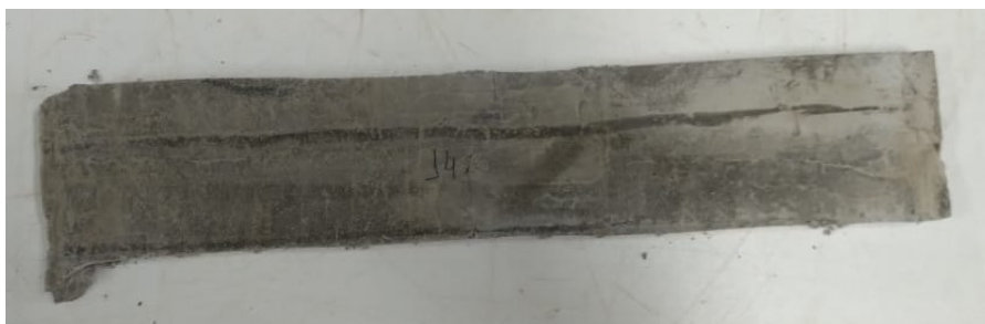
FIGURA 11: Corpo de prova de dimensões 20cm x 4 cm e espessura de 0,6 cm.
