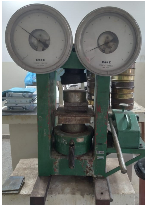
FIGURA 9: Dispositivo utilizado para prensagem das placas
