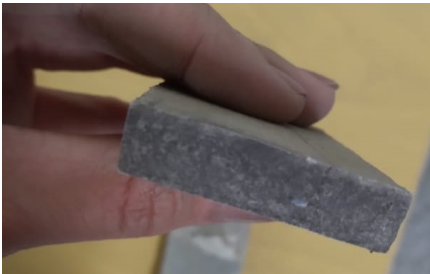
FIGURA 14: Seção transversal do corpo de prova após a ruptura
