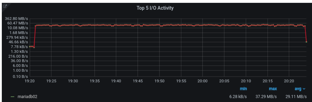
Figura 22 – Segundo cenário. Arquitetura single-node. Consumo de disco. Eixo Y em escala logarítmica.
