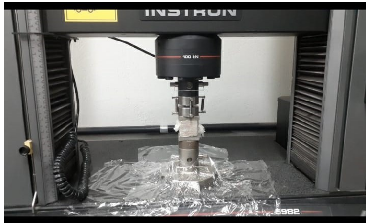
Figura 7: Amostra posicionada para o Ensaio de Compressão.
