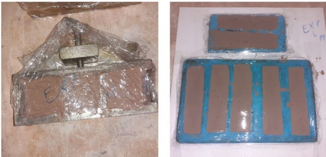
Figura 6: Corpos de prova moldados e embalados.
