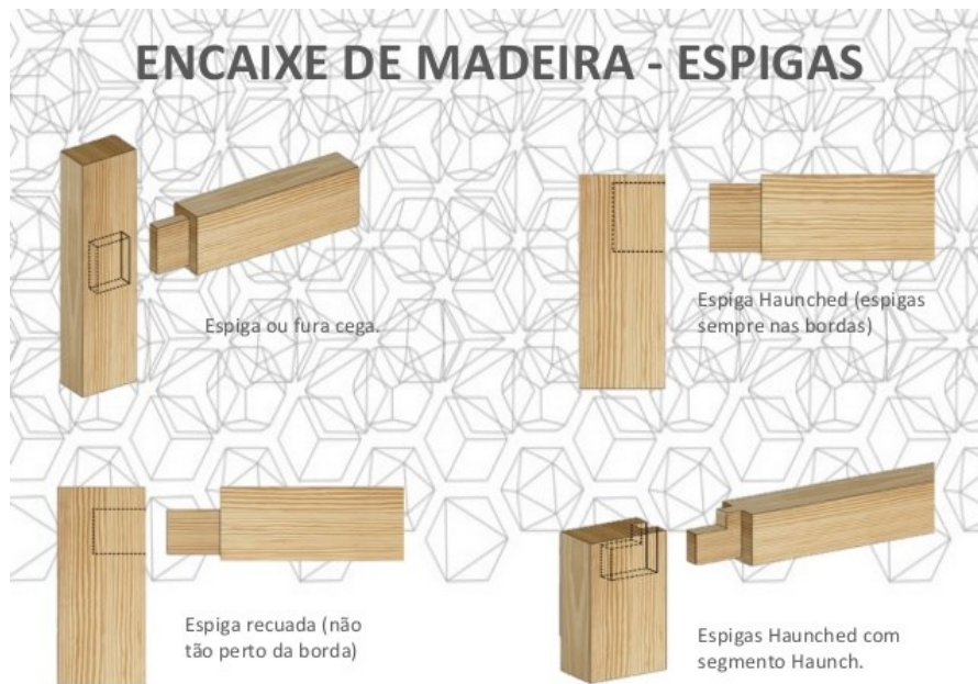
Figura 60: Tipo de encaixe espiga; Fonte: http://woodsecondchance.blogspot.com/
