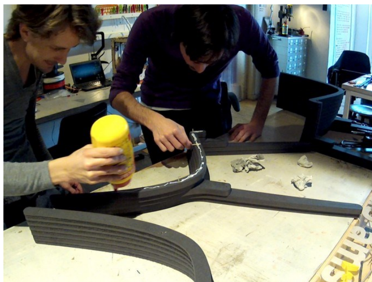
Figura 47: Processo de fabricação colagem das camadas para obter a cadeira tridimensionalmente. Fonte: http://www.dyvikdesign.com/
