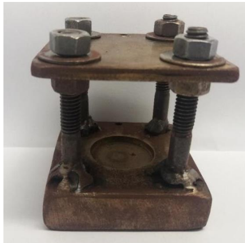
Figura 18-Suporte para cadinho projetado e usinado para a preparação de nanopartículas de quitosana
