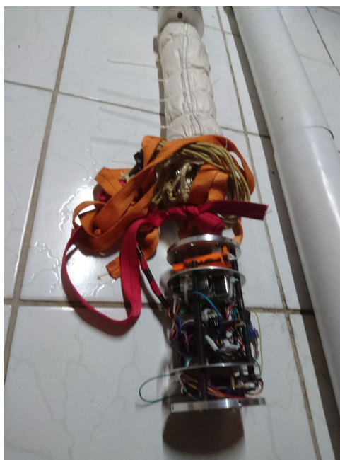
Figura 6 – Sistema de recuperação criado pela EPTA para a cooperação inter equipes da COBRUF 2017.
