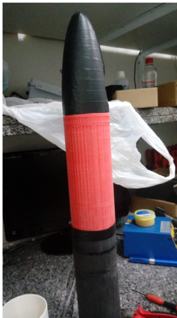
Figura 3 – Fuselagem feita em PETG (Polietileno Tereftalato de Etileno Glicol) para o foguete Vésper 1a, da Equipe de Propulsão e Tecnologia Aeroespacial (EPTA).
