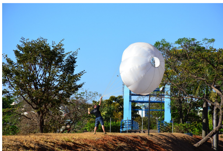
Figura 7 – Paraquedas hemisférico com spill hole feito pela EPTA para a cooperação inter equipes da COBRUF 2017.
