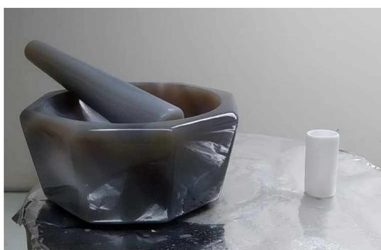
Figura 3.1 – Almofariz e pilão utilizados para o processo de mistura dos reagentes, ambos são feitos de ágata. A ágata é interessante por não conter poros, ser de fácil limpeza e não reagir com a amostra.
