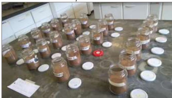
Figura 2 - Amostras de solo divididas em potes “Solo Não Contaminado”, “Solo Contaminado”, “Solo Contaminado revolvido”, “Solo Contaminado revolvido e tratado com nutrientes” e “Solo Controle” para um experimento.
