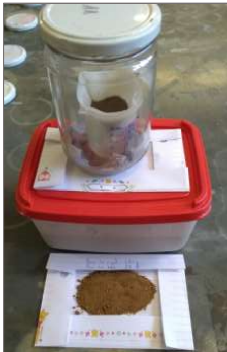
Figura 4 - Imagem do experimento de capacidade de retenção de água (béquer dentro do pote) e de umidade do solo amostrado (papel com 10g que foi a estufa).
