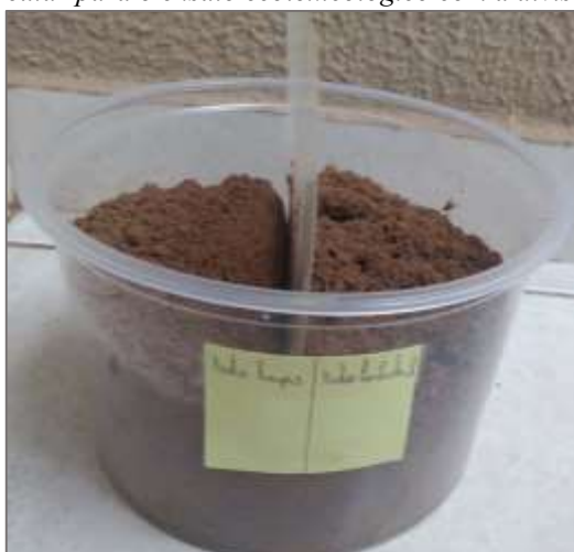
Figura 7 - Recipiente teste circular para o ensaio ecotoxicológico com a divisória entre as amostras de solo.
