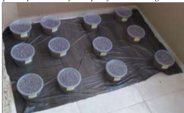
Figura 9 - Teste de fuga montado em recipientes, com 5cm de altura de solo, 10 minhocas por pote e lacrado por tampa levemente furada para facilitar trocas gasosas. .
