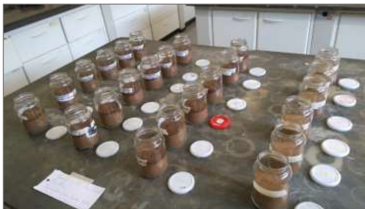
Figura 5 – Solo contaminado por óleo lubrificante queimado com o contaminante apenas nos primeiros centímetros do solo.
