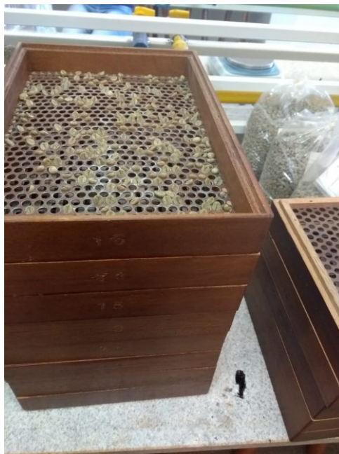
Figura 7. Pesagem dos grãos retidos nas peneiras.
