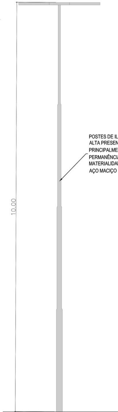
POSTES DE ILUMINAÇÃO DE ALTURA ALTA PRESENTES NAS PRINCIPALMENTE NAS ÁREAS DE PERMANÊNCIA DO PARQUE. MATERIALIDADE: ESTRUTURA DE AÇO MACIÇO E LÂMPADA DE LED
