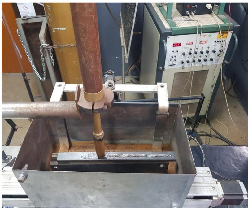
Figura 10: Fonte, mesa e tocha de soldagem utilizados para os testes.
