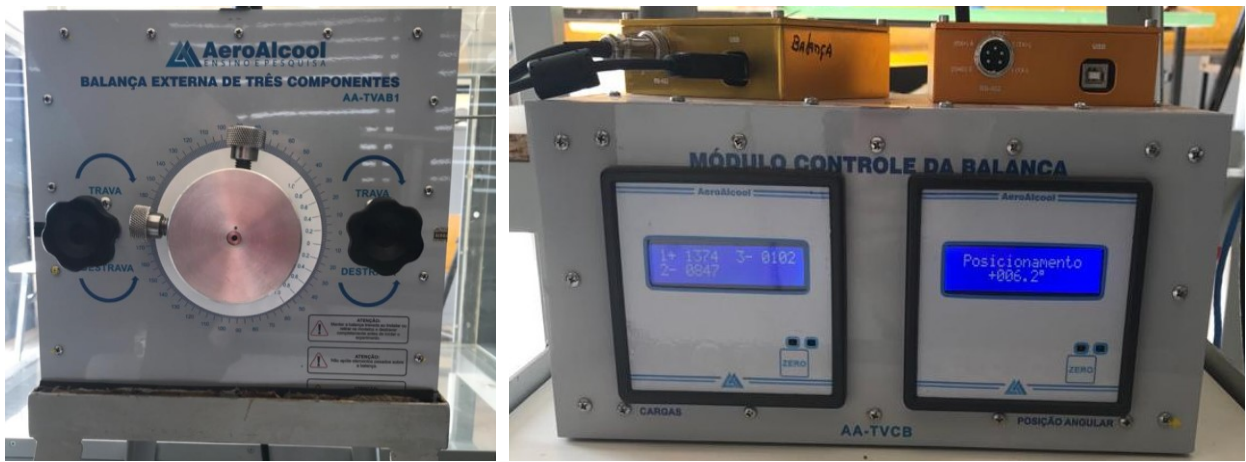
Figura 28 - Balança Aerodinâmica AA-TVAB1 (LAEX/CPAERO-UFU)
