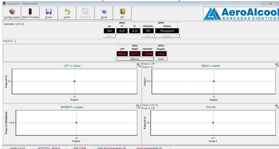
Figura 29 – Sistema de aquisição de dados da AA-DAS da balança aerodinâmica (LAEX/CPAERO-UFU)
