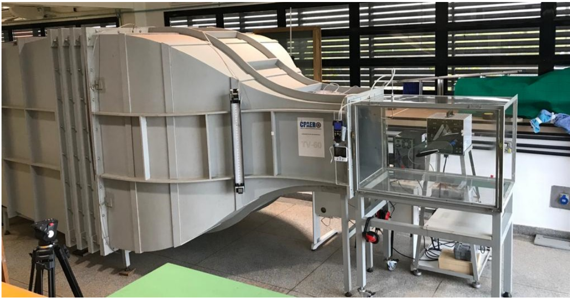
Figura 23 - Túnel de vento TV60 (LAEX/CPAERO -UFU)
