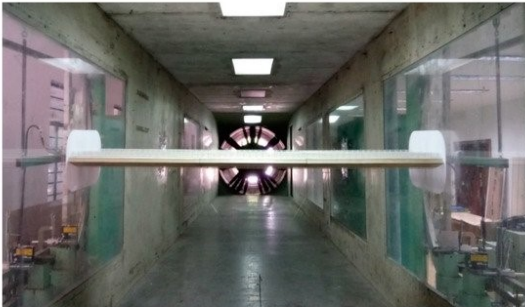
Figura 18 - Vista do aerofólio posicionado na seção de teste do túnel de vento com as end-plates nas extremidades do perfil.
