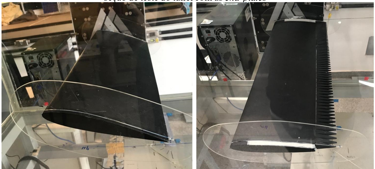
Figura 43 - Aerofólio baseline e com bordo de fuga serrilhado respectivamente, posicionados na seção de teste do túnel com as end-plates
