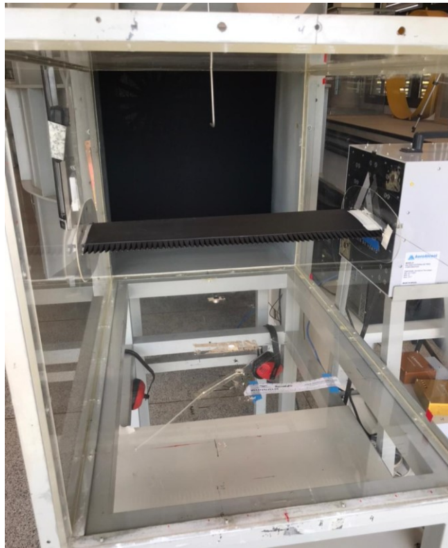
Figura 24 - Seção de teste do Túnel de vento (LAEX/CPAERO UFU)
