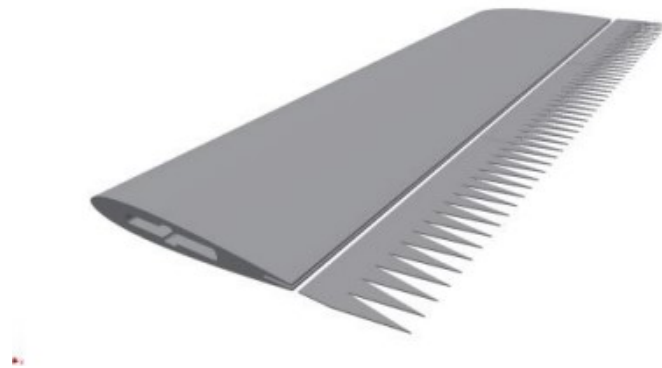
Figura 21 - Vista de montagem no CAD do NACA 0012 com a inserção do serrilhado
