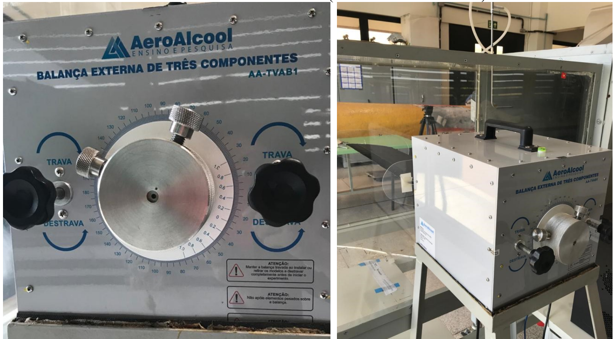
Figura 45 - Variação do ângulo de ataque na segunda escala e posicionamento da balança aerodinâmica no túnel de vento (LAEX/CPAERO-UFU)
