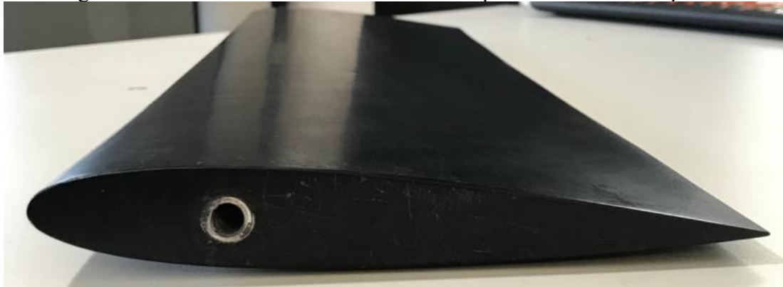
Figura 35 - aerofólio baseline com recorte no ponto \frac{1}{4} de corda impresso
