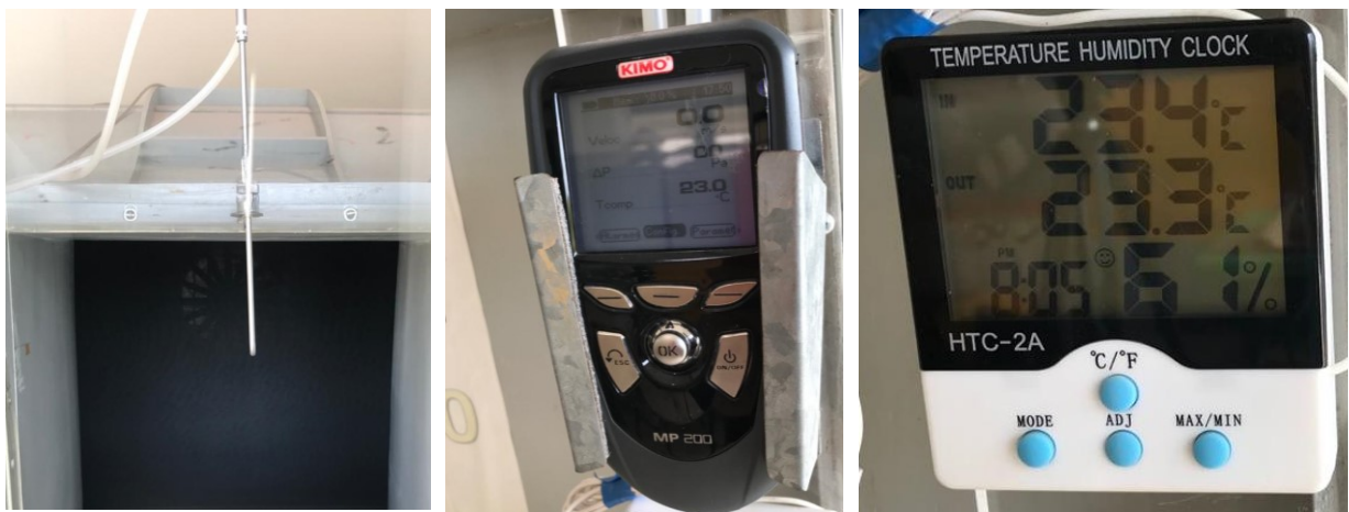
Figura 25 - Tubo de Pitot, manômetro digital e medidor de temperatura (LAEX/CPAERO UFU)
