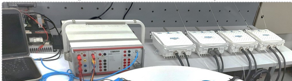
Figura 11 – Fonte de PONOVO W460 usada na calibração.
