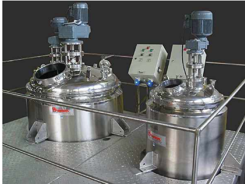
Figura 9 – Vista superior de tanques reatores com controle de temperatura.
