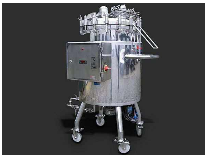
Figura 8 – Reator batelada utilizado na produção de fotoprotetores.
