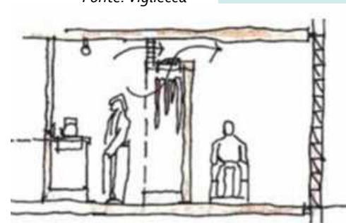
Figura 28 Esquema que mostra o sistema de ventilação cruzada implantado nos dormitórios Fonte: Vigliecca
