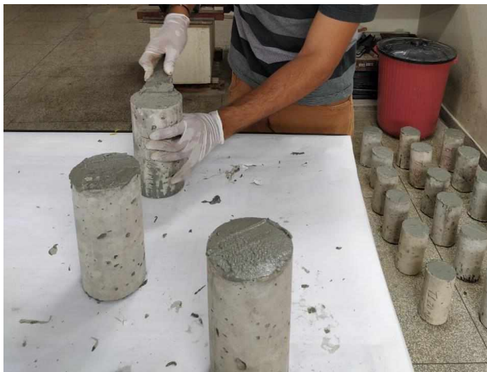
Figura 29 - Vedação dos corpos-de-prova com resina epóxi.
