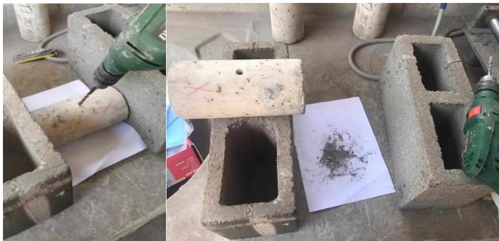
Figura 32a e 32b – Extração e obtenção do material pulverulento.
