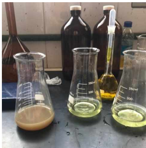
Figura 37 - Adição do \text{AgNO}_3 à solução com \text{K}_2\text{CrO}_4
