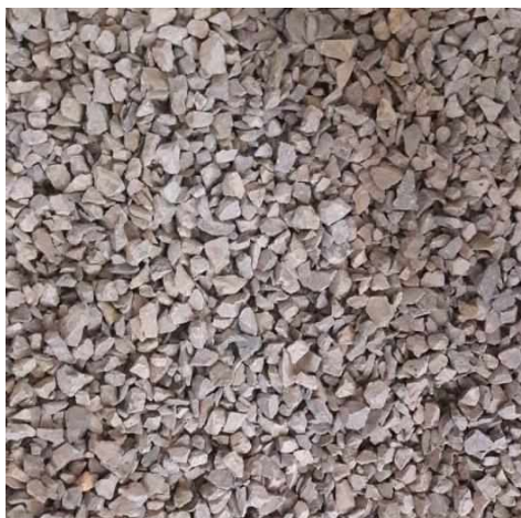
Figura 22- Agregado graúdo, do tipo brita 1, utilizado para confecção do concreto
