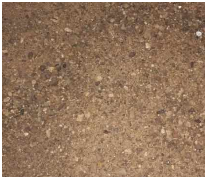
Figura 23 - Agregado miúdo, do tipo areia média, utilizado para confecção do concreto
