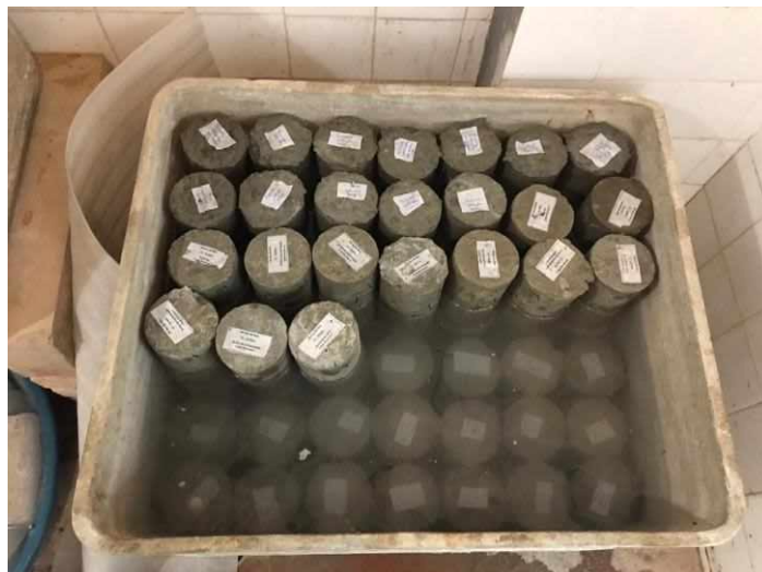
Figura 27 - Imersão dos corpos de prova para o processo de cura
