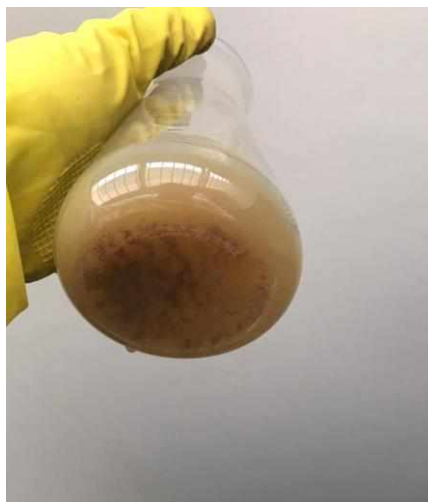
Figura 38 - Reação do \text{AgNO}_3 em contato com a solução com \text{K}_2\text{CrO}_4
