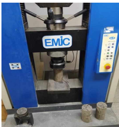
Figura 28 - Ensaio de resistência à compressão
