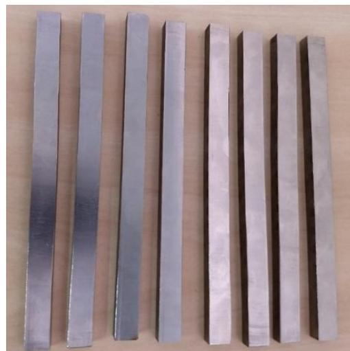
Figura 4.28 - Corpos de prova após os processos de usinagem.
