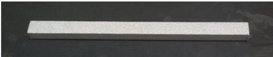
Figura 4.39 – Corpo de prova metalizado com alumínio.
