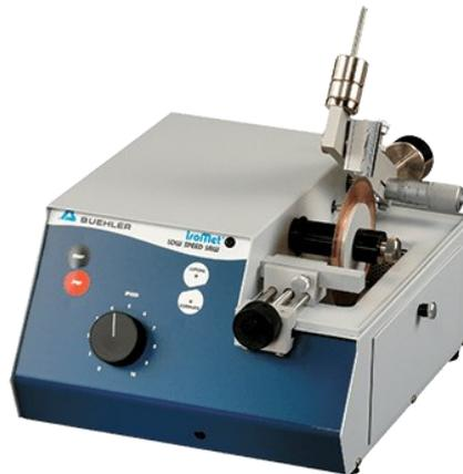
Figura 4.49 – Cortadeira IsoMet, de fabricação da Buehler, utilizada para corte refrigerado em baixa velocidade. Esta foi utilizada para realizar o corte longitudinal nas amostras sem danificar o revestimento nem a camada de óxido gerada na superfície da amostra durante os testes.
