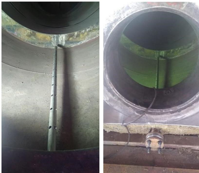
Figura 4.33 - Porta-amostra com os corpos de prova instalados no superaquecedor.
