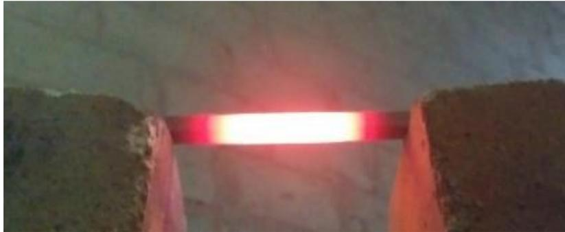
Figura 4.41 –Aquecimento do corpo de prova metalizado com Colmonoy 6 a fim de melhorar a adesão da metalização ao substrato. Tal processo se mostrou inviável para aplicação em campo e não foi utilizado nos corpos de prova que foram submetidos a testes.
