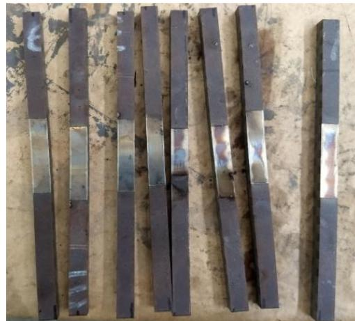
Figura 4.27 - Amostras cortadas por eletroerosão a fio.
