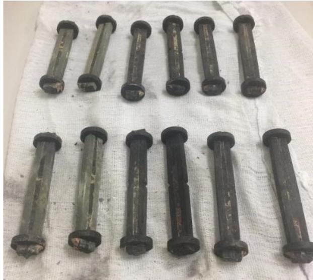
Figura 4.34 – Corpos de prova assim que removidos do superaquecedor.
