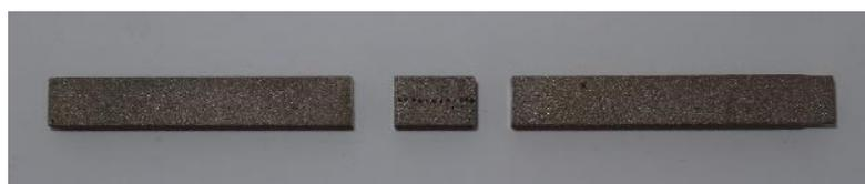
Figura 4.48 – Corte transversal nos corpos de prova que não foram submetidos aos ensaios.
