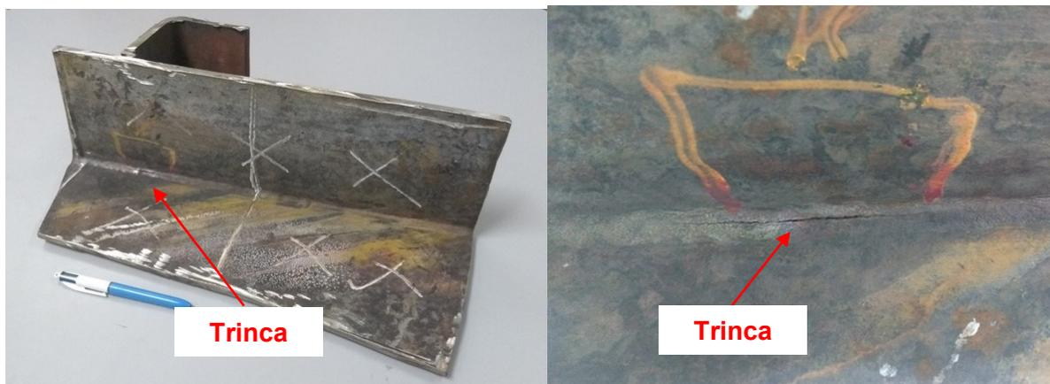
Figura 1.6 – Amostra com uma trinca não passante removida do superaquecedor para análise preliminar. A figura a direita mostra com maior detalhe a trinca.
