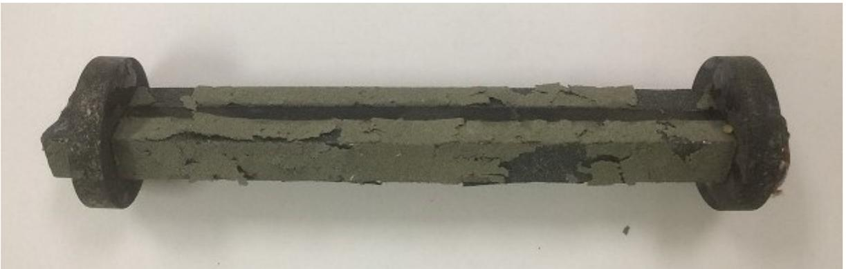
Figura 5.3 – Corpo de prova revestido em alumínio, após a remoção do superaquecedor. É possível ver o destacamento da camada de alumínio.
