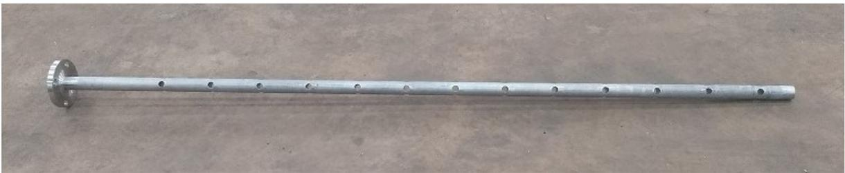
Figura 4.6 – Porta-amostra depois de fabricado.
