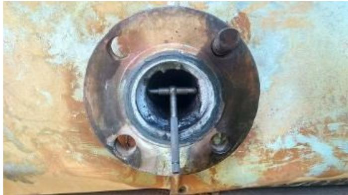
Figura 4.2 – Medição do diâmetro interno para montagem do porta-amostra; medida encontrada = 48,5 mm.
