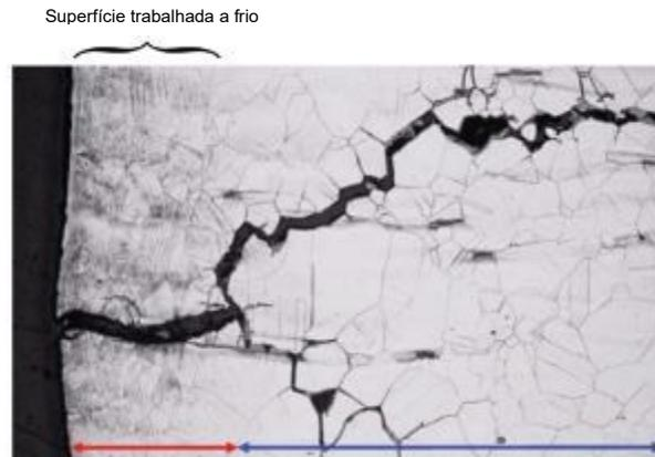
Figura 2.3 - Corrosão sob tensão (CST) em aço inoxidável a partir da camada trabalhada a frio como CST transgranular (seta vermelha) e continuando no material base como intergranular (seta azul) (STAEHLE, 2016), modificado.
