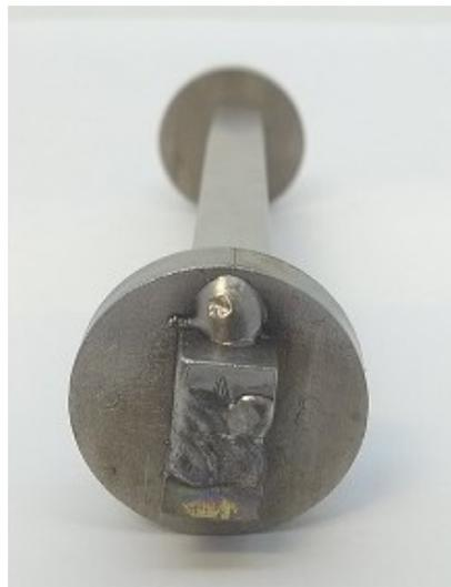
Figura 4.32 - Extremidade soldada do conjunto de corpos de prova.
