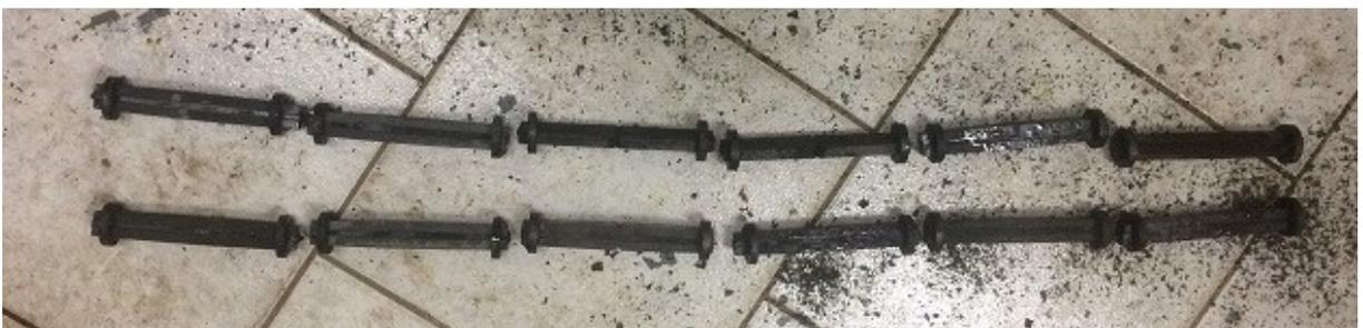
Figura 5.1 – Corpos de prova removidos para inspeção após 2160 horas no superaquecedor.
