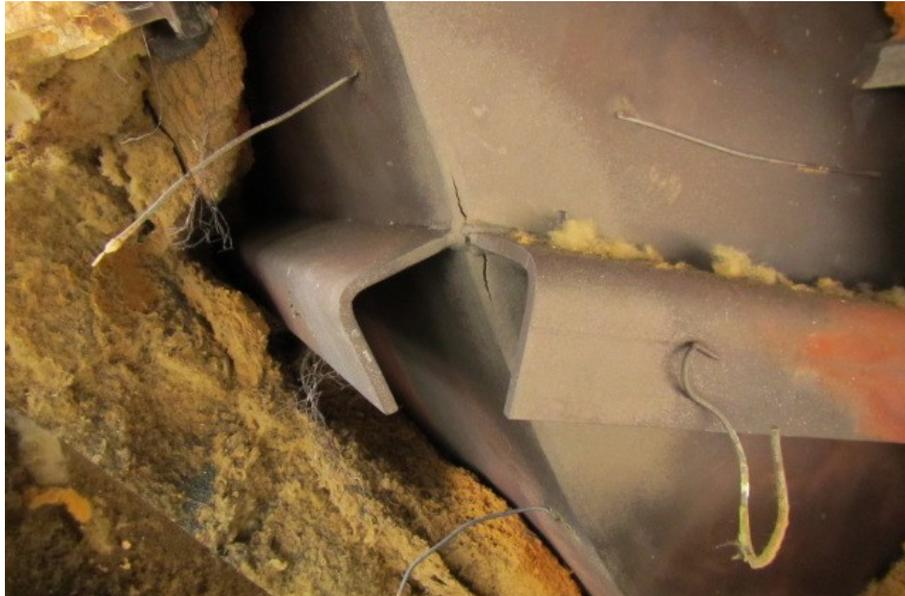
Figura 1.4 – Trinca em uma região de concentração de tensão no costado do superaquecedor.
