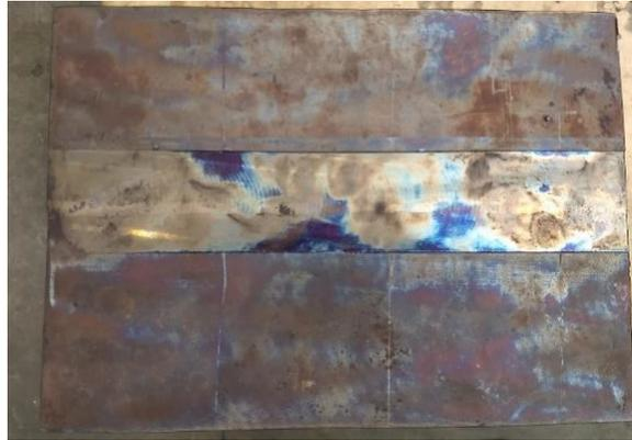
Figura 4.26 - Junta soldada após o alívio de tensões e usinagem dos reforços de solda.
