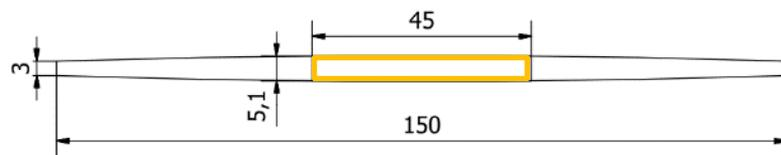
Figura 4.18 – Espaçador central com retângulo em amarelo mostrando os locais de coleta da medida (s) e (h) para utilização do cálculo da norma ASTM G39-99 (2016).
