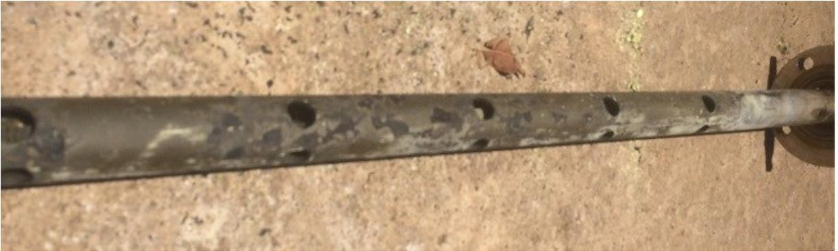
Figura 5.2 – Porta-amostra logo após a remoção do superaquecedor.
