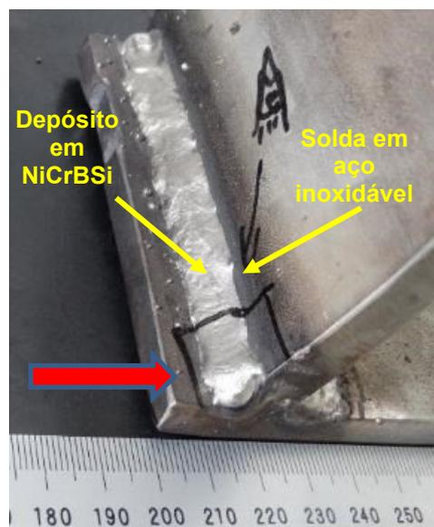
Figura 4.38 - Depósito gerado pelo procedimento 2, aplicado sobre a solda de aço inoxidável. A seta em vermelho indica regiões em baixo relevo, que funcionariam como concentradores de tensão na peça.
