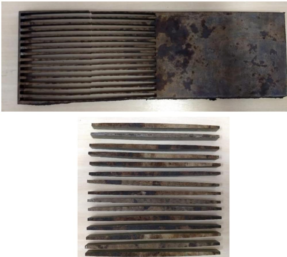
Figura 4.29 - Espaçadores cortados por eletroerosão a fio.
