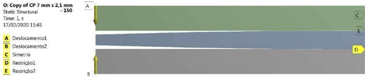
Figura 4.21 – Condições de contorno para realizar a simulação no corpo de prova sem entalhe.
