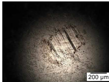
Figura 4-10 Imagem microscópio óptico da (a) trilha de desgaste e a (b) marca de desgaste do contra corpo do ensaio com lubrificação e com textura.
