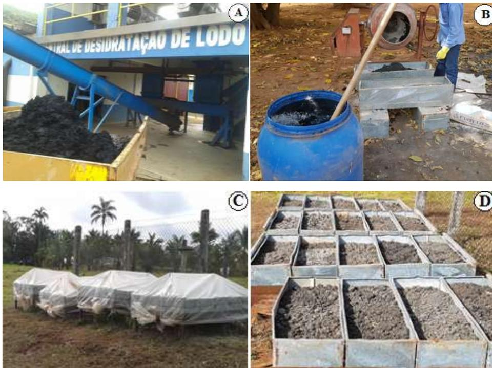
**Figura 2.** Processo de eliminação de patógenos do lodo de esgoto. Resíduo sólido centrifugado (A); tratamento com cal hidratada (B); exposição a raios ultravioletas (C) e secagem ao ar livre (D).
