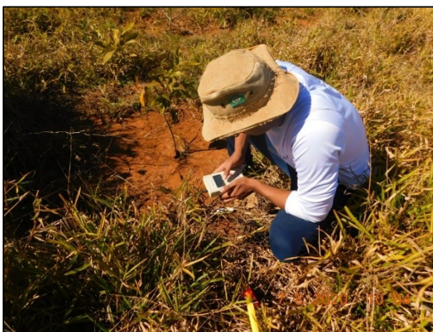
Figura 6: Realização das medições de umidade do solo usando uma sonda TDR.
