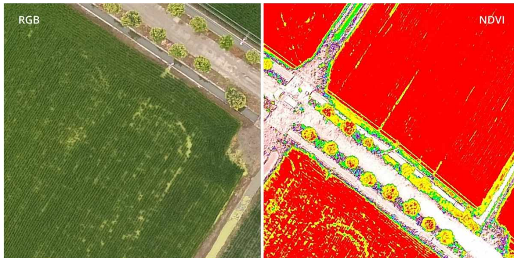
Figura 3 – Identificação de características do campo utilizando NDVI
