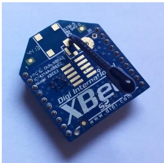
Figura 2.1 – Módulo Xbee Series 2 (elaborada pelo autor).
