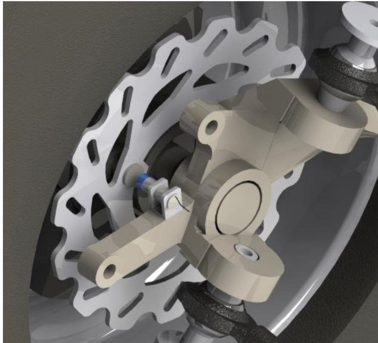
Figura 3.8 – Instalação sensor indutivo tubular I18-5-DPC-K12 (elaborada pelo autor).
