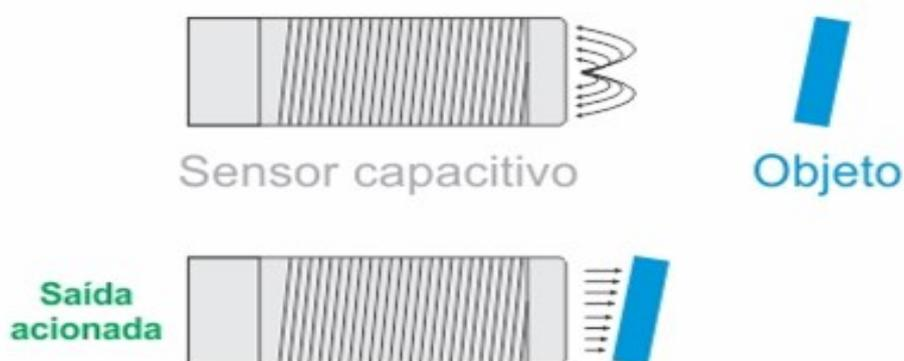
Figura 3.2 – Princípio de funcionamento do sensor capacitivo (Disponível em: <http://profcolassante.blogspot.com/2015/06/sensores-capacitivos-e-indutivos.html>. Acesso em Abril 2020).
