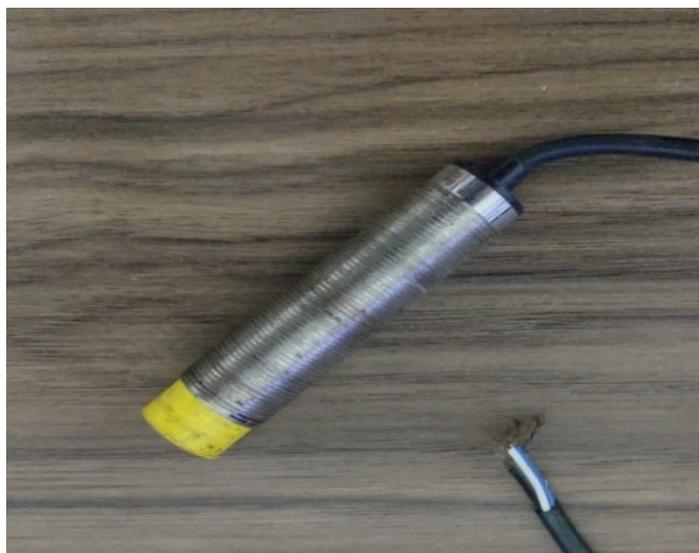
Figura 3.3 – Sensor capacitivo tubular C18-8-DPC (elaborada pelo autor).
