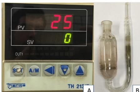
Figura 8: (A) Controlador de Temperatura; (B) Reator usado na passivação dos catalisadores.
