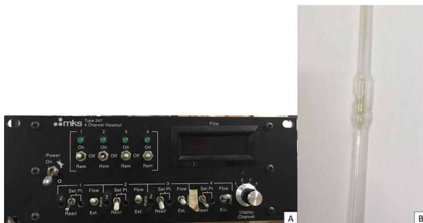
Figura 10: (A) MKS usado no controle do fluxo de  $H_2$ ; (B) Reator de quartzo usado na reação.
