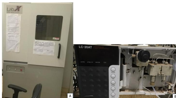
Figura 9: (A) Difratômetro usado no DRX; (B) Bomba usada no bombeamento de guaiacol no reator.
