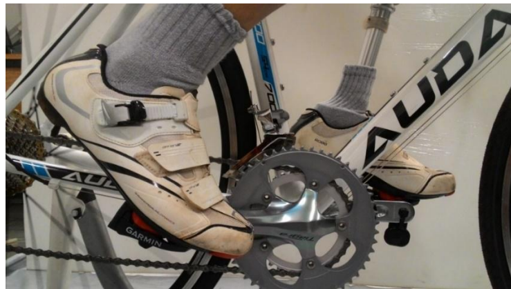
Figura 3.4 – Montagem dos sensores de potência nos pedais da bicicleta.
