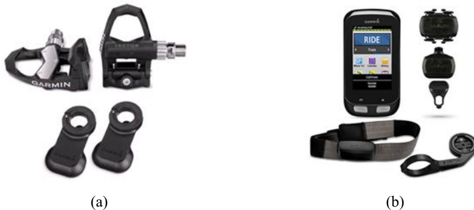
Figura 3.3 - (a) Sensores de potência, modelo Vector 2 e (b) e o ciclo-computador, modelo Edge Bundle 1000, ambos do fabricante Garmin.
