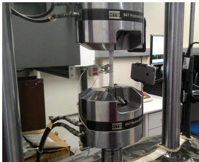
Figura 3.23 – Montagem dos dispositivos e dos corpos de prova na máquina de ensaios.
