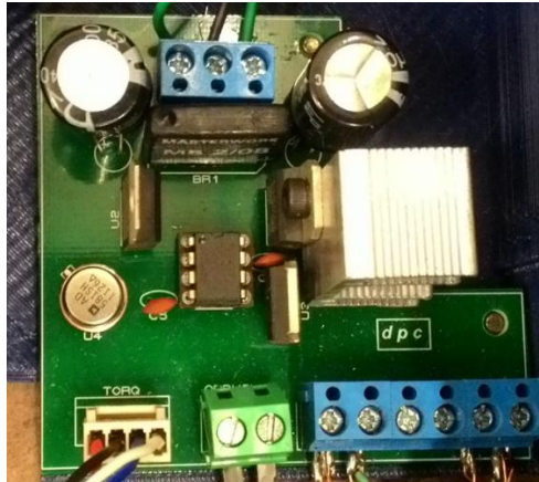
Figura 4.5 – Placa amplificadora e de alimentação, com seus respectivos componentes soldados.
