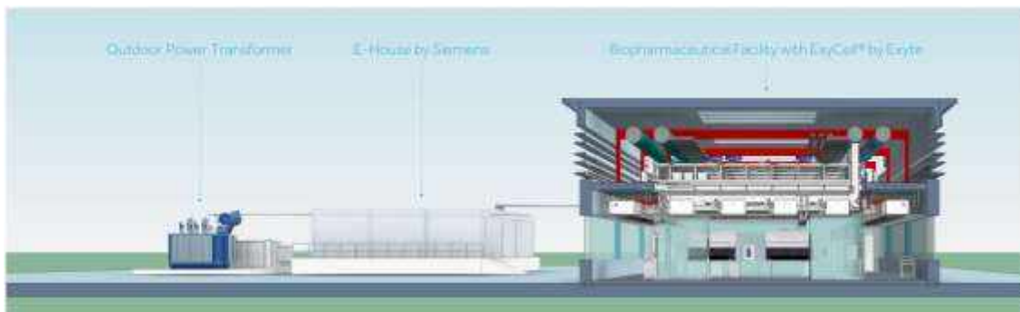
Figura 13: Instalação biofarmacêutica composta por módulos Exycell e alimentação integrada da Siemens.
