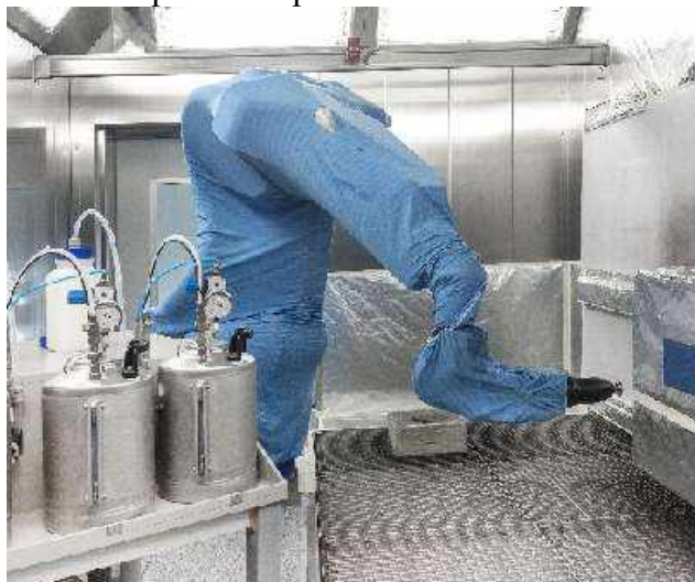
Figura 15: Robô utilizado pela Basf para simular movimentos na linha de pintura.
