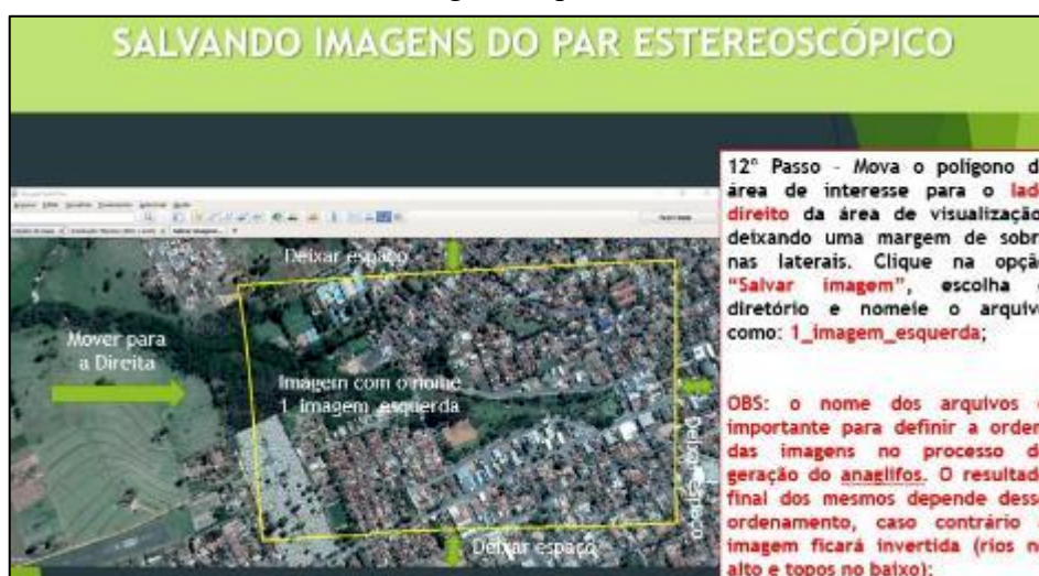
Figura 48. Mover a imagem para o seu lado direito e salvar o arquivo com o nome “imagem esquerda”
