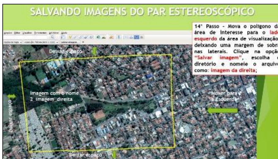
Figura 50. Mover a imagem para o seu lado esquerdo e salvar o arquivo com o nome “imagem direita”
