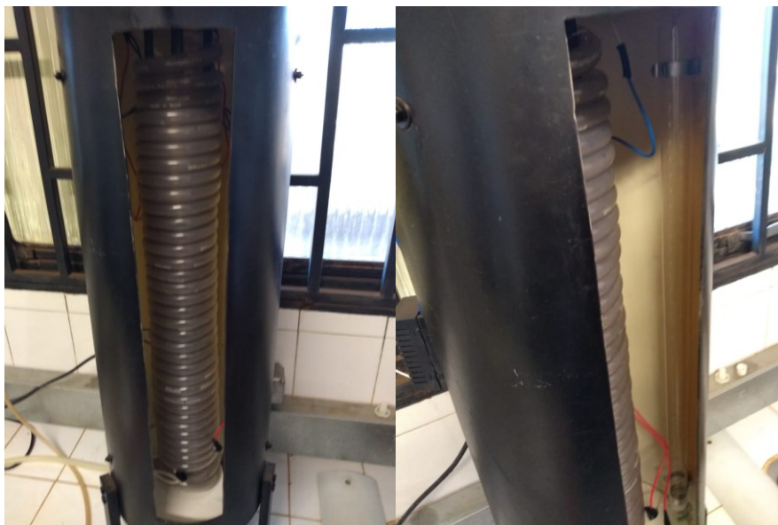
Figura 5 – Fotorreator: visão da mangueira de circulação e de uma das lâmpadas germicidas
