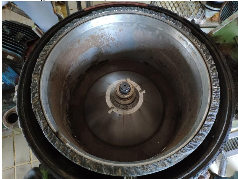
Figura 17 – Vista superior do anel 14 de bloqueio.
