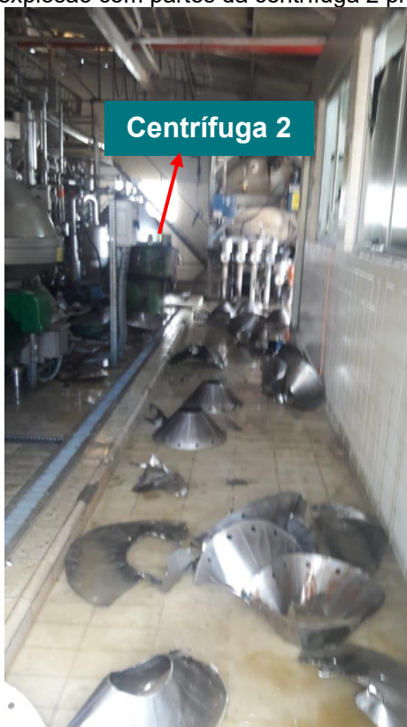
Figura 10 – Momento após a explosão com partes da centrífuga 2 projetadas pela sala de controle.
